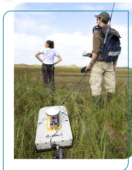
Christopher Hein et Julie Billy, manipulant l'acquisition des données géophysiques à terre (GPR) (crédit photo : CNRS photothèque Thibaut Vergoz)
