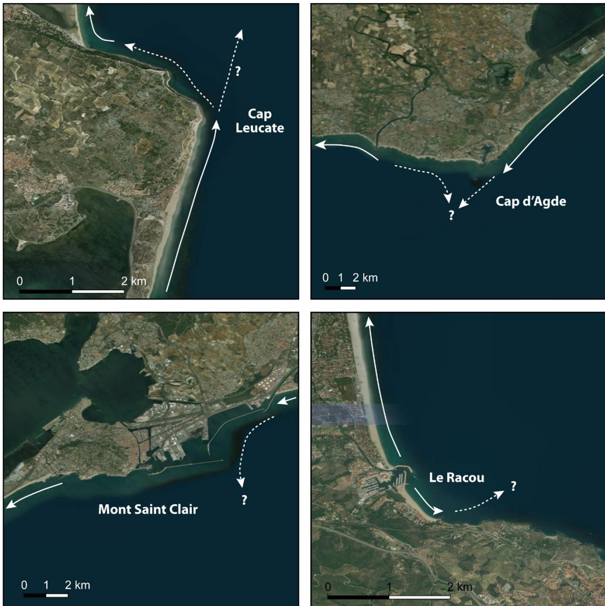
Figure 1 : Photo satellite des trois principaux cap rocheux (Cap Leucate, Cap d'Agde et Mont Saint Clair) et de la terminaison sud de la cellule hydrosédimentaire du Roussillon (Plage du Racou) présentant la direction de transports connue et les pertes supposées.
