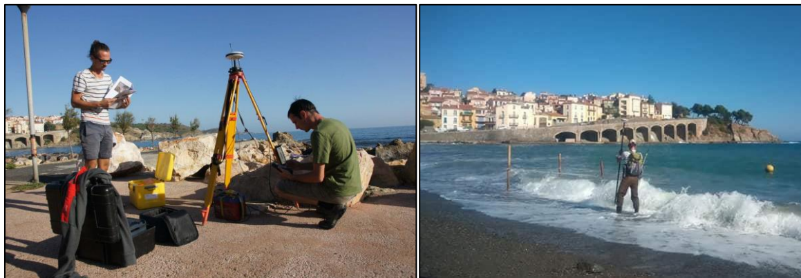
Figure 6 : Mise en place de la base DGPS et levé du trait de côte sur la plage de Banyuls.
