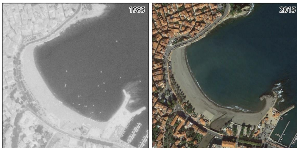
Figure 47 : Photographie aérienne de la baie de Banyuls en 1985 (à gauche) et 2015 (à droite) montrant l'ajout de l'épi-courbe au sud de la baie pour stopper le transport des sédiments vers le large.
